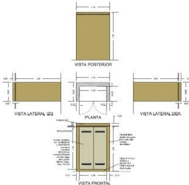
La ubicación del gabinete debe respetar las normas de distancias a fuegos abiertos (grupo electrógeno, parrilla, vehículos, fuentes de calor, etc), llaves de luz, luminarias, pilares de energía eléctrica, etc. TANQUES 0,5m<sub>3</sub>
