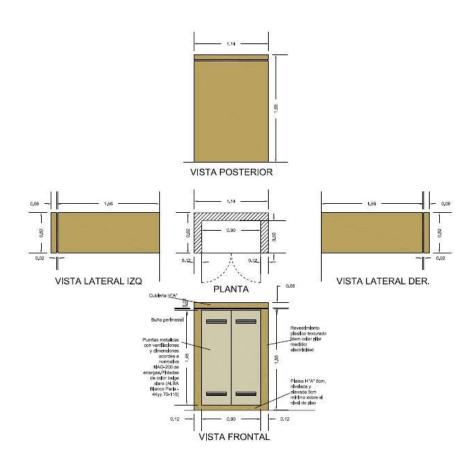
La ubicación del gabinete debe respetar las normas de distancias a fuegos abiertos (grupo electrógeno, parrilla, vehículos, fuentes de calor, etc), llaves de luz, luminarias, pilares de energía eléctrica, etc.
