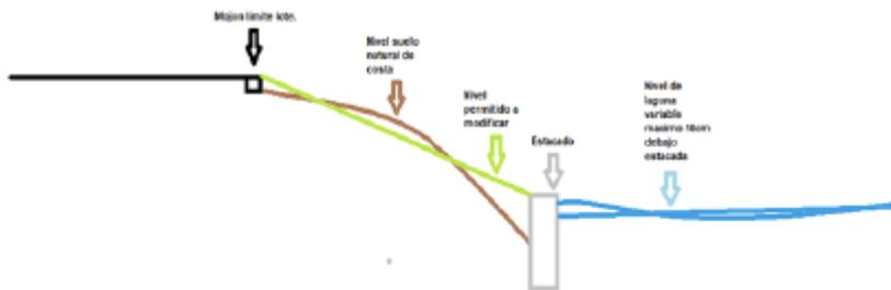
\*El nivel de pendiente variará según sector de la laguna en referencia a la marcación del equipo topográfico.
