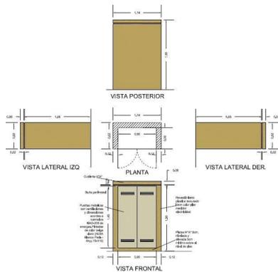
La ubicación del gabinete debe respetar las normas de distancias a fuegos abiertos (grupo electrógeno, parrilla, vehículos, fuentes de calor, etc), llaves de luz, luminarias, pilares de energía eléctrica, etc.
